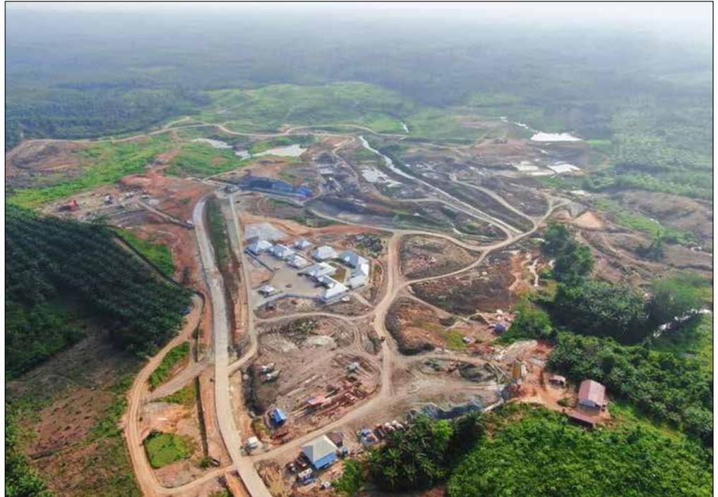
Bendungan yang berlokasi di Desa Tengin Baru, Kecamatan Sepaku ini memiliki panjang bendungan 450 meter, sementara tipe bendungan adalah uruk tanah homogen.
